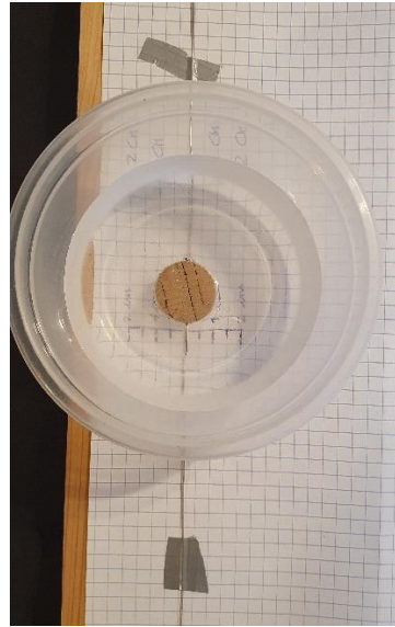
Figura 27: si allinea il filo all'aghetto magnetizzato
