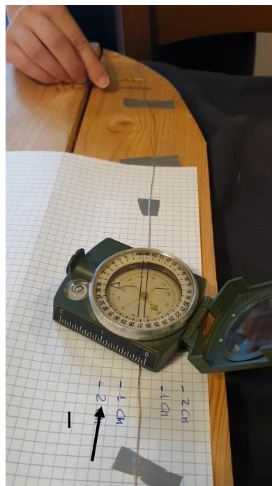
Figura 18: circuito chiuso, ago della bussola si sposta verso ovest
