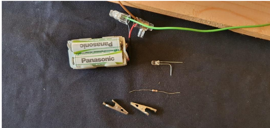
Figura 1: pacco batterie, LED, resistenza e coccodrilli
