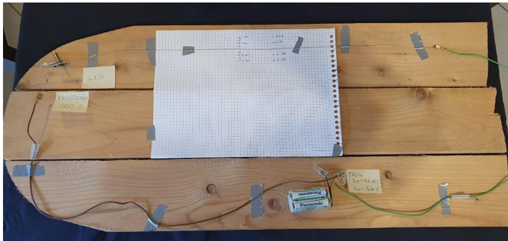
Figura 10: si invertono di posizione catodo e anodo del LED, alla chiusura del circuito il LED non si accende (NB questa operazione va fatta con basse tensioni applicate per non danneggiare il LED)
