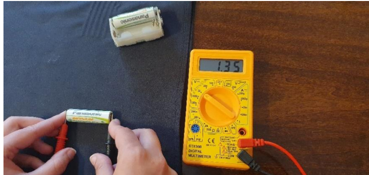
Figura 3: misura della forza elettromotrice di una pila
