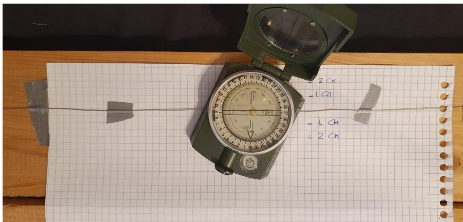
Figura 13: filo orientato nella direzione nord-sud
