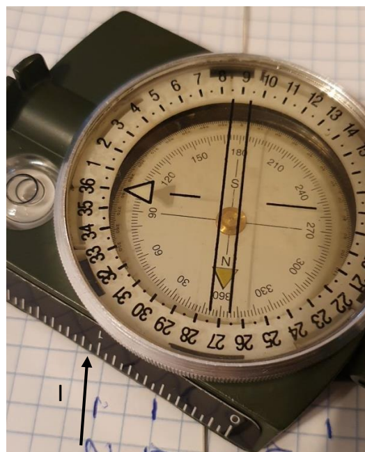
Figura 25: circuito chiuso, ago della bussola si sposta di all'incirca 2° verso ovest
