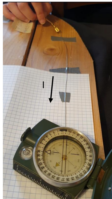
Figura 16: circuito chiuso, ago della bussola si sposta verso est
