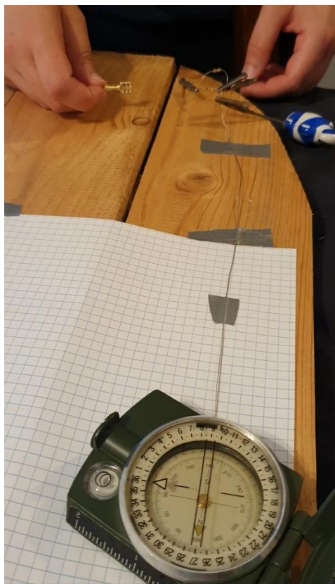
Figura 23: sistema di misura del campo magnetico generato dal filo con 2 resistenze in parallelo
