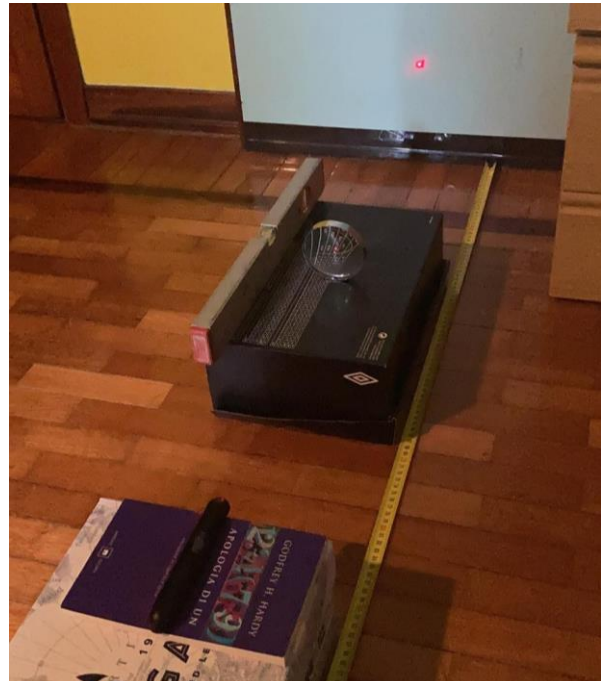
Determinazione asse ottico tramite puntatore laser - Celada
