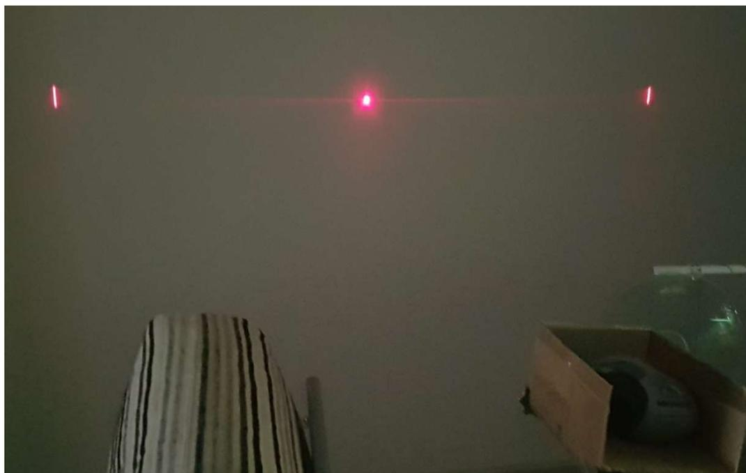
Figura 6 Figura di diffrazione (configurazione1)
