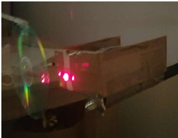
Figura 5 Set-up sperimentale per la verifica della corretta parallasse tra laser, schermo e CD
